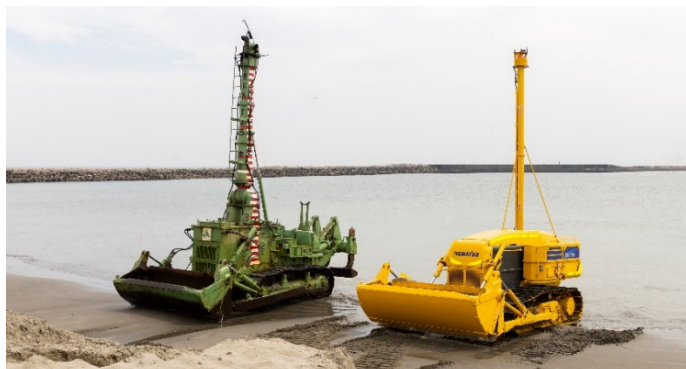
【水陸両用ブルドーザー（写真左）と 実証中の水中施工ロボット（写真右）】
