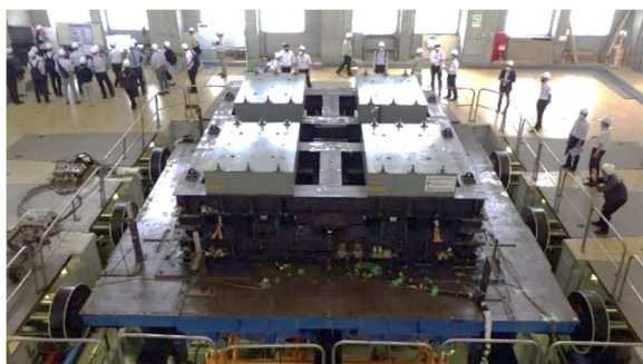
写真2 大型振動台実験状況
