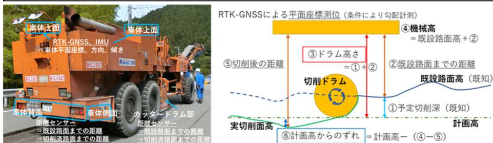
後付け装置による切削機ICT化の方法
